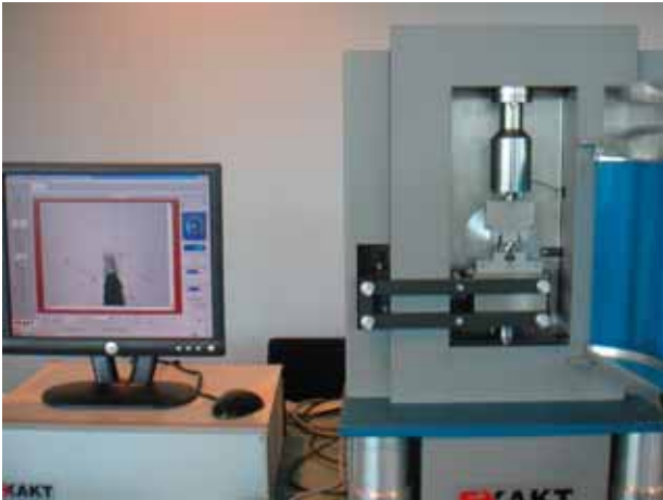
Fig. 7 クラック進展挙動のリアルタイム計測システム
