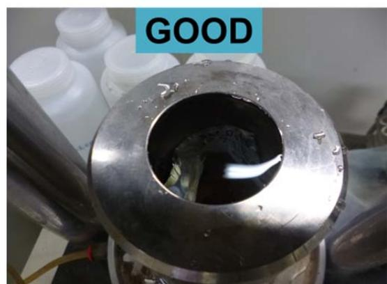
8. 上の弁を最後まできっちり締める。この時にチューブから水があふれだすことを確認する。水が出ないようならば放水弁が閉まっているので圧力をかけた際にパッキンが破裂し、危険である。周りが水浸しにならないか注意する。
