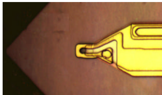
図5 . 内径2 \mu\text{m} のSQUIDセンサ・コイル部分の顕微鏡写真。Si基板の角の部分に実装されている。
