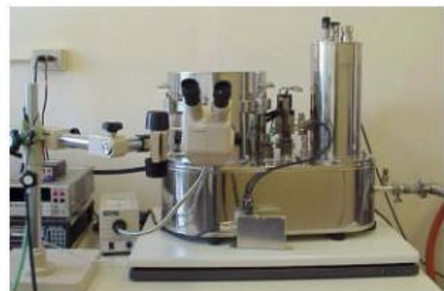
図 2 . セイコ - インストルメンツ社製の SQUID 磁気顕微鏡 SFI2000 の本体部分
