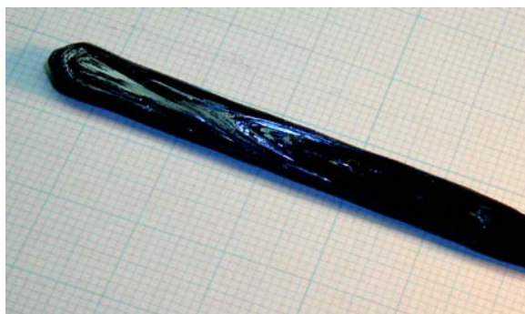
図2. 育成された高品質単結晶 \text{Bi}_2\text{Sr}_2\text{CaCu}_2\text{O}_{8+\delta} の一例。背景は1 mm 方眼紙。
