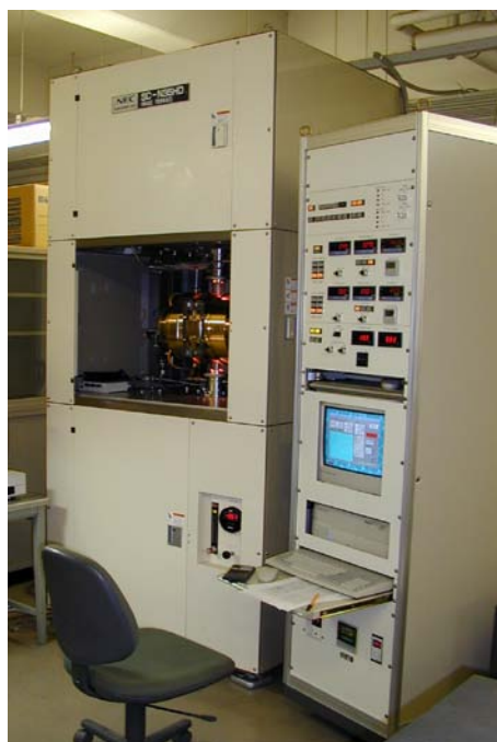
図 1. 高純度大型単結晶製造装置の外観。右側がコントロールパネル、左側が単結晶育成装置本体（動作中）。
