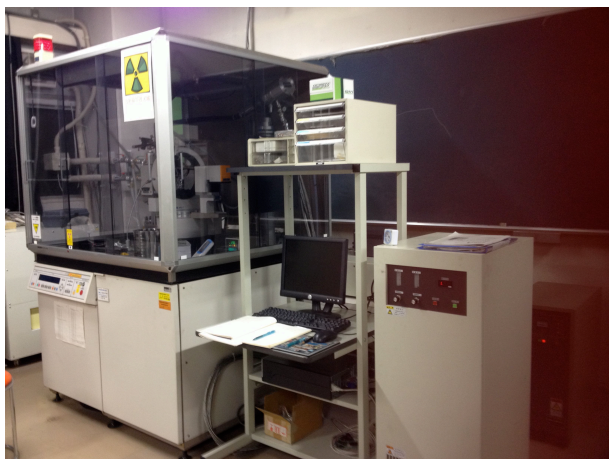
低温窒素吹付型 4 軸回折計 AFC7R (RIGAKU)
