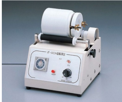
図 4.3 市販の実験室用ボールミル(理化学機器サイト、アズワンカタログより)
