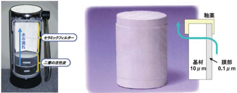
図 14.2 多孔質セラミックスを用いた再生可能な浄水フィルター(日本ガイシ) (出典: セラミックス, 43 (2008) 416)
