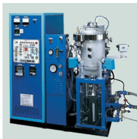
図 6.2 多目的高温炉 (ハイマルチ、富士電波製) 87 (出典: http://www.fujidempa.co.jp/thermo.html )
