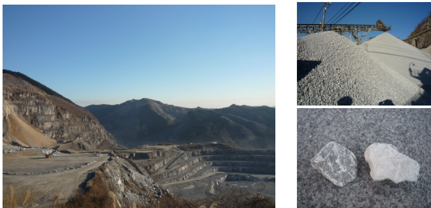
図 3.5 国産石灰石・ドロマイト採掘場の例(栃木県佐野市大叶鉱山); (左)階段状に広がる石灰石・ドロマイト採石場, (右上)破碎・水洗後の石灰石, (右下)石灰石(左)とドロマイト(右). (撮影:鈴木 義和)
