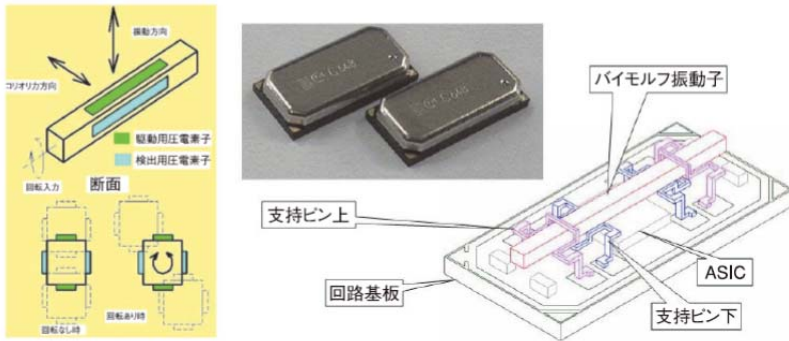
図 10.3 圧電ジャイロの原理と構造(セラミックス, 42 [6] 448 (2006).)
