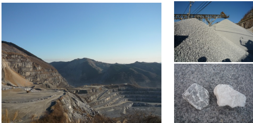
図 3.5 国産石灰石・ドロマイト採掘場の例(栃木県佐野市大叶鉱山); (左)階段状に広がる石灰石・ドロマイト採石場, (右上)破碎・水洗後の石灰石, (右下)石灰石(左)とドロマイト(右). (撮影:鈴木 義和)
